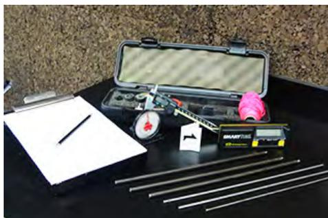
Para establecer la posible ubicación del tirador o tiradores —origen de fuego— utiliza los siguientes instrumentos: las varillas metálicas de diferentes diámetros, pabilos de colores y láser para materializar la trayectoria balística; y el eclímetro para obtener el ángulo de incidencia.
